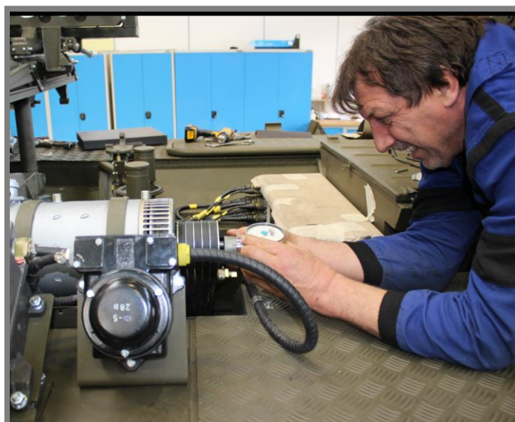
Obr. 16 Měření otáček na dynamu
