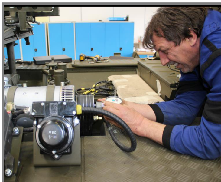
Obr. 16 Měření otáček na dynamu
