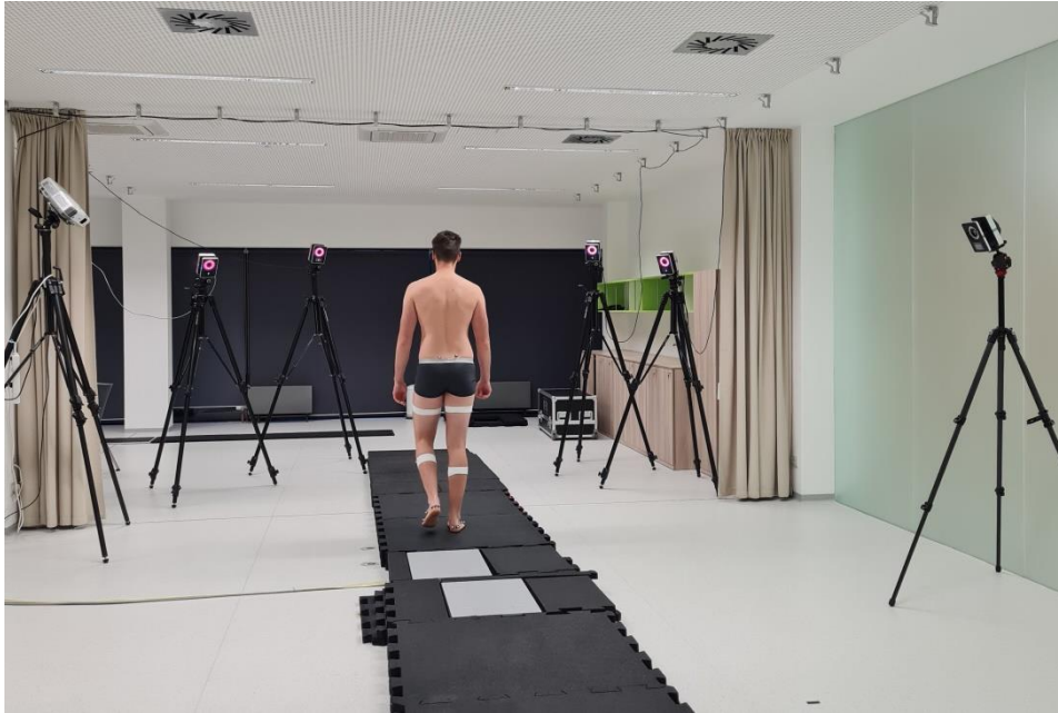
Obrázek 12. Umístění silových plošin při měření
