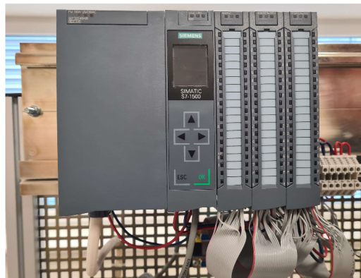
Obr. 1.1: Výukový panel s PLC S7-1500
