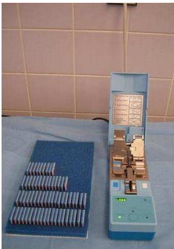
Obrázek 9: Sterilní svářečka TCD B40 Haemonetics a svařovací nože
