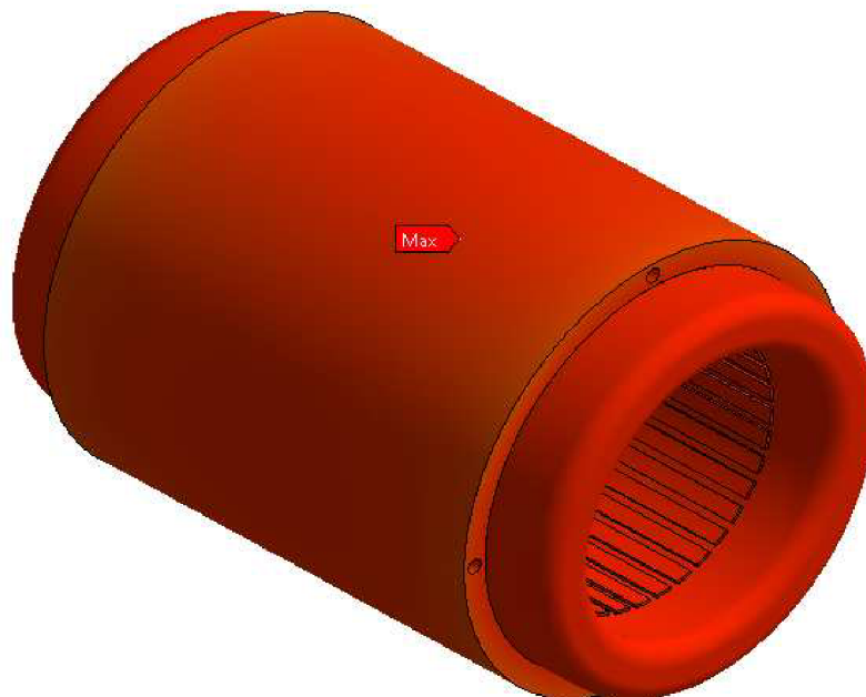
Obr. č. 16 Rozložení teploty na modelu statoru
