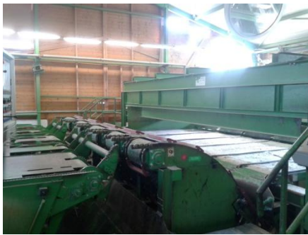
Obr. 11: Automatický omítací uzel
