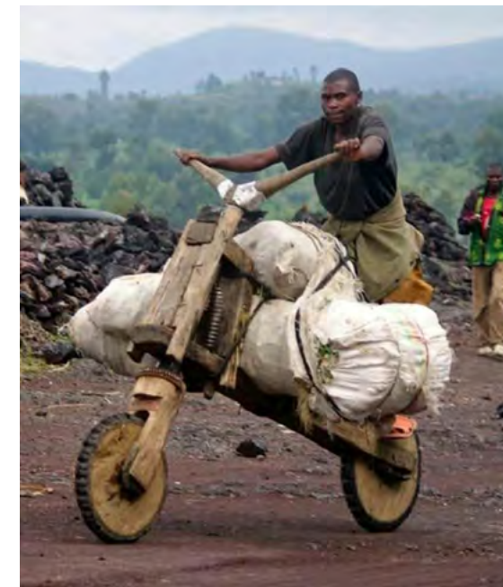
[26] přeprava materiálů na chuduku
