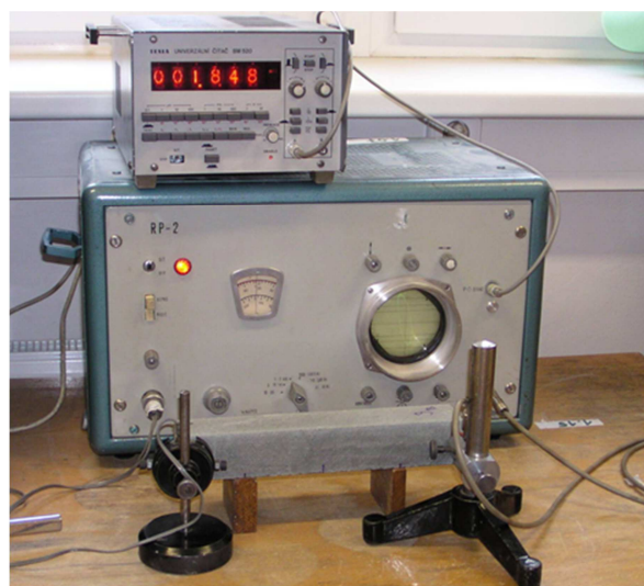
Obr. 27 Zařízení pro měření kontinuální rezonanční metodou [37]
