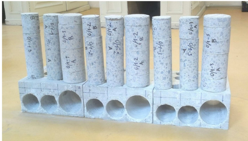
Obr. 30 Odebrané jádrové vývrty
