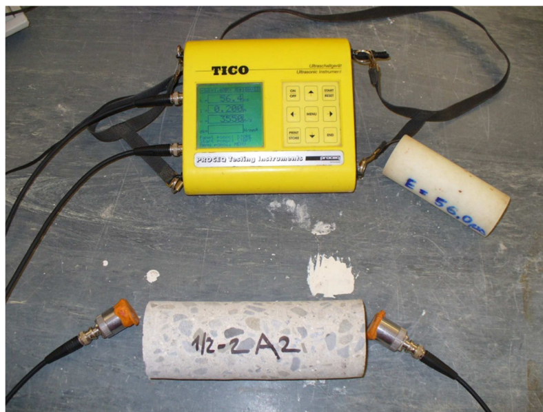
Obr. 22 Ultrazvukový přístroj TICO od firmy Proceq [3]
