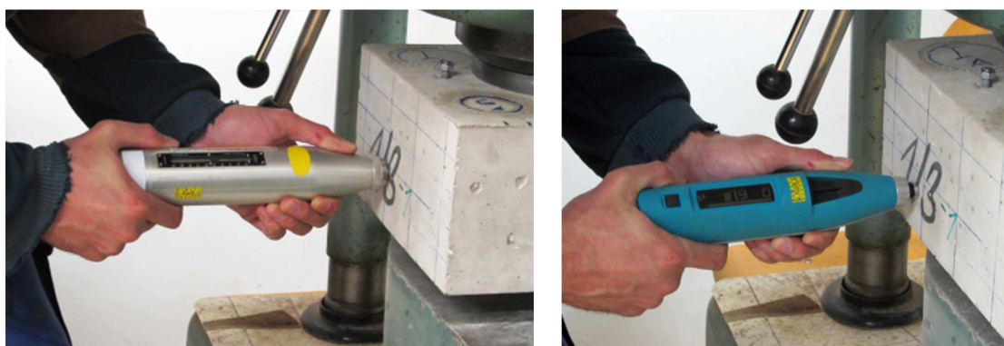
Obr. 31 a) Měření Schmidtovým tvrdoměrem typu N; b) Měření pomocí tvrdoměru Silver Schmidt [53]
