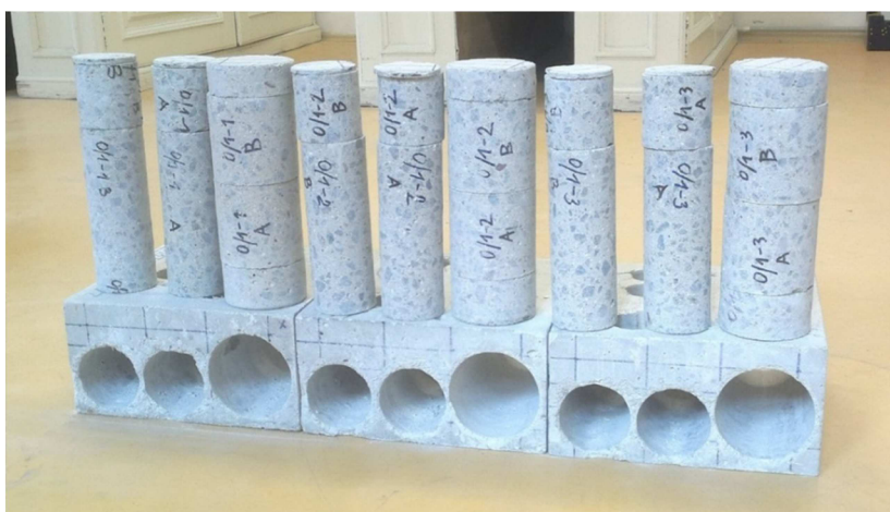
Obr. 30 Odebrané jádrové vývrtů
