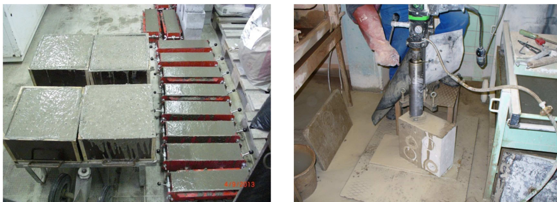
Obr. 30 a) Výroba betonových bloků; b) odběr jádrových vývrtů [3]
