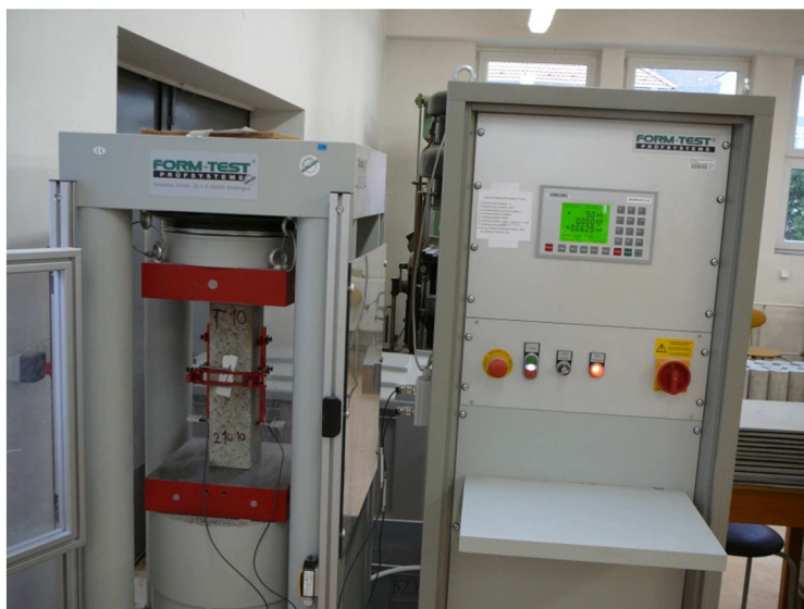
Obr. 18 Měření statického modulu pružnosti betonu v tlaku ve zkušebním lisu [39]
