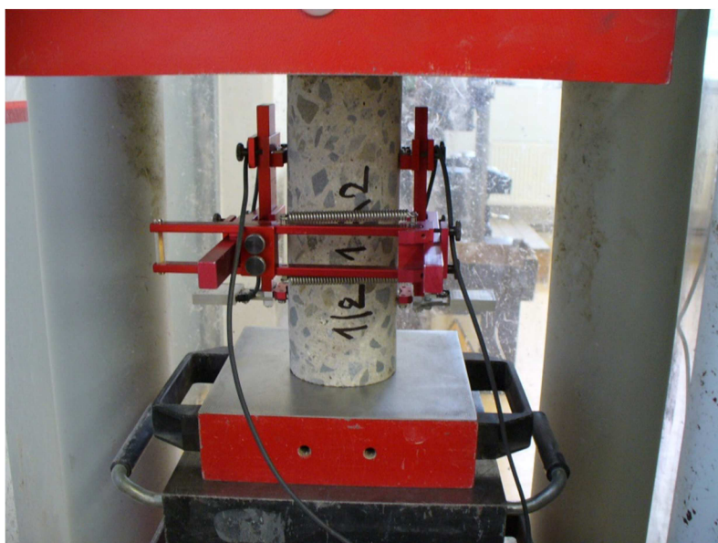
Obr. 34 Zatěžování vzorku v hydraulickém lisu při měření statického modulu pružnosti v tlaku
