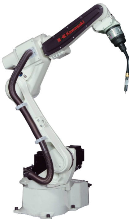
Obrázek 2.4: Průmyslový robot BA006N od společnosti Kawasaki, který je primárně určený ke svařování 5 .
