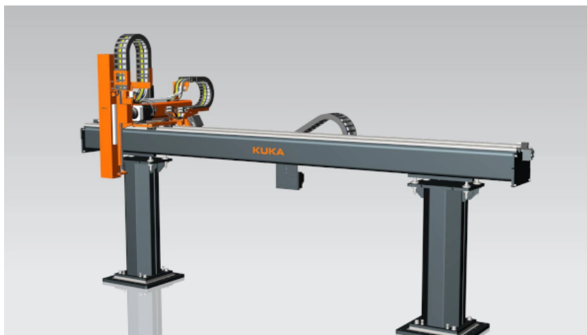
Obrázek 2.6: Ukázka kartézského robotu od společnosti KUKA 7 .
