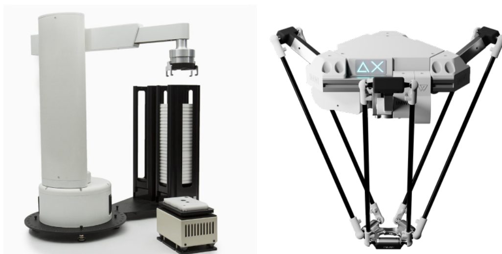
Obrázek 2.8: Ukázka cylindrického robotu 9 a robotu typu delta 10 .
