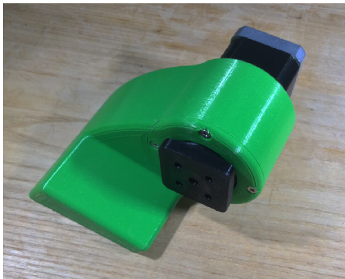
Obrázek 4.6: Ukázka prvního funkčního prototypu sedla.
