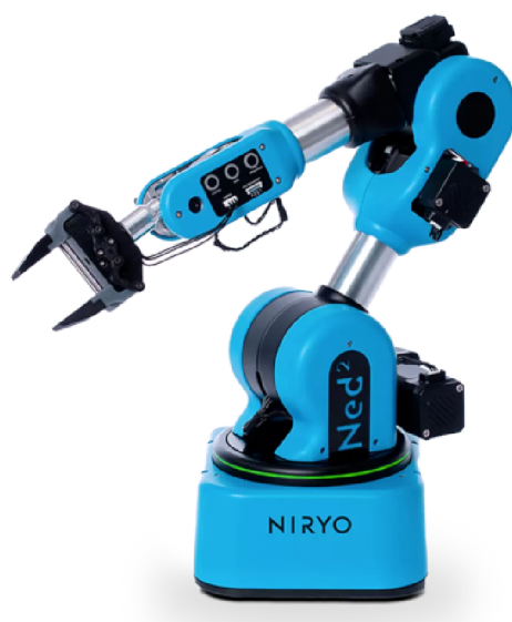
Obrázek 2.9: Nízkonákladový průmyslový robot NIRYO Ned2 15 .
