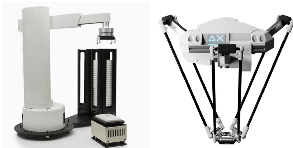
Obrázek 2.8: Ukázka cylindrického robotu 9 a robotu typu delta 10 .
