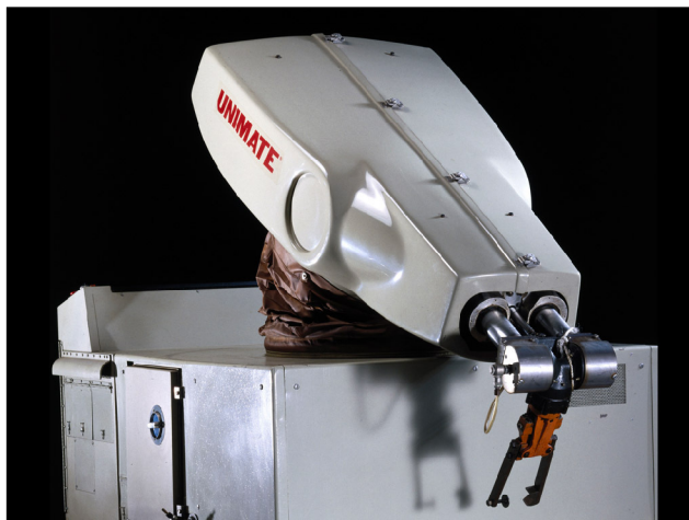
Obrázek 2.3: První průmyslový robot Unimate zkonstruovaný roku 1961 v USA 4 .
