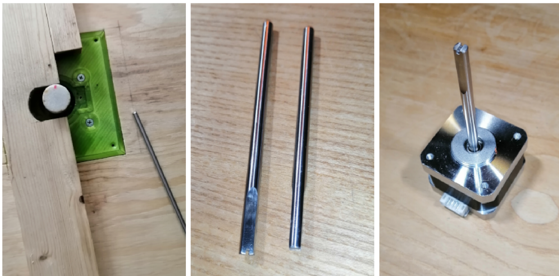
Obrázek 4.8: Výroba hřídele a finální výsledek včetně výměny původní.
