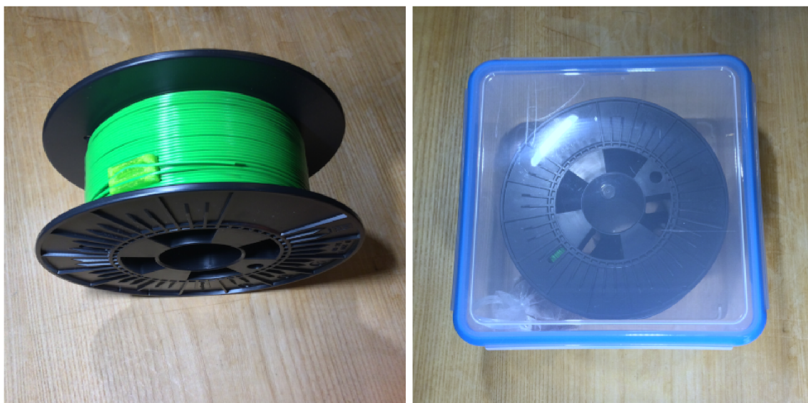
Obrázek 3.4: Ukázka 1 kg špulky filamentu a jedna z možností jejího správného skladování. Ve spodní části boxu se nachází vak se silica gelem pro pohlcování vlhkosti.
