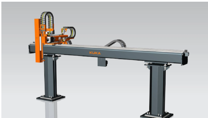
Obrázek 2.6: Ukázka kartézského robotu od společnosti KUKA 7 .
