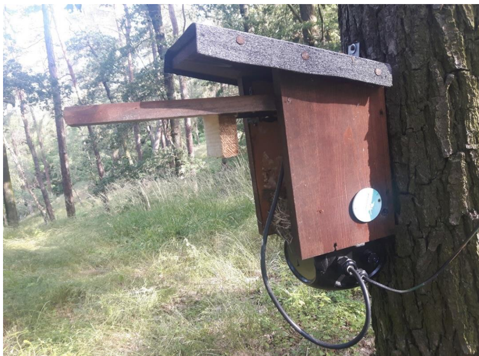
Obr. č. 1: Otevřená hnízdní budka s ochranným prkénkem proti predátorům a nainstalovanou RFID čtečkou (Foto: Vojtěch Lyko).
