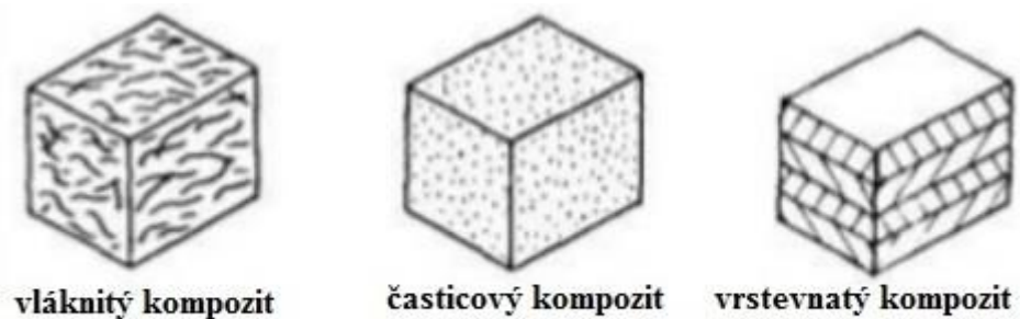
Obr.10 Schematické znázornenie delenia kompozitov 16
