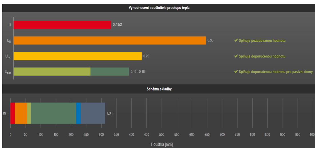
Obrázek 20 – Grafické znázornění výpočtu součinitele prostupu tepla pro STN 3 [autor]
