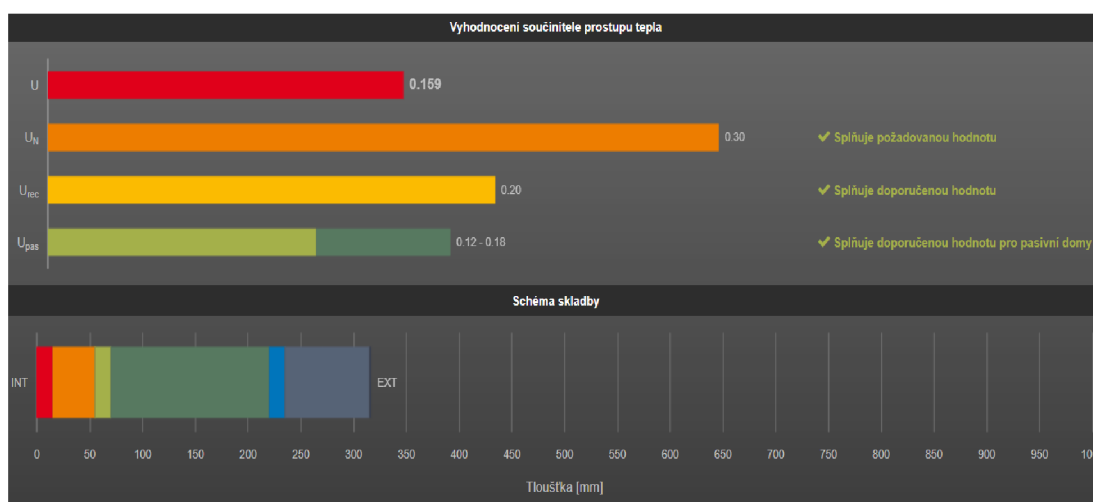
Obrázek 24 – Grafické znázornění výpočtu součinitele prostupu tepla pro STN 7 [autor]
