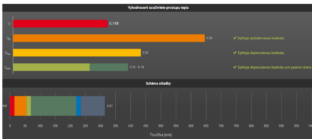
Obrázek 19 – Grafické znázornění výpočtu součinitele prostupu tepla pro STN 2 [autor]
