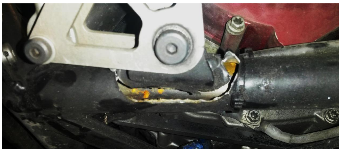
Obr. 32 Zlyhanie uchytenia držiaku vahadla na vozidla Dragon 5
