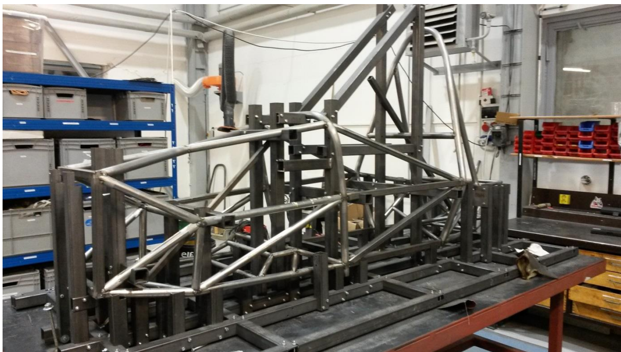
Obr. 47 Rám vyskladaný v prípravku na zváranie
