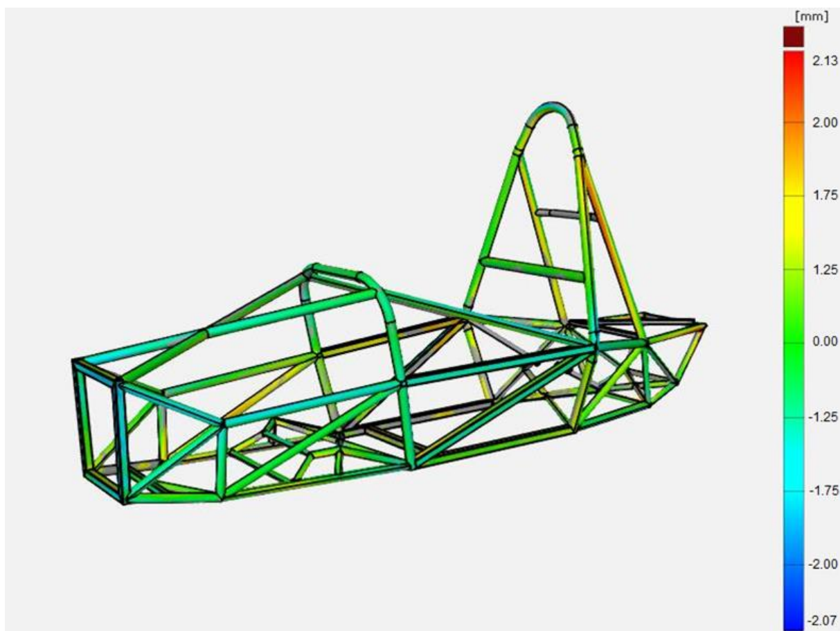
Obr. 49 Porovnanie skenu rámu s CAD modelom
