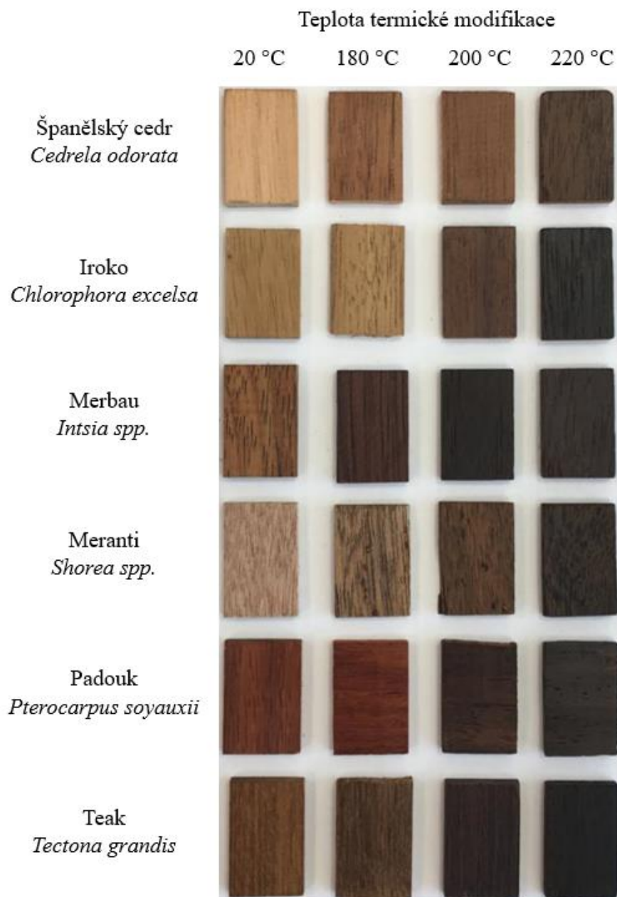
Obr. 8. Vzorky exotických dřev, pro měření UV-Vis difúzní reflektance
