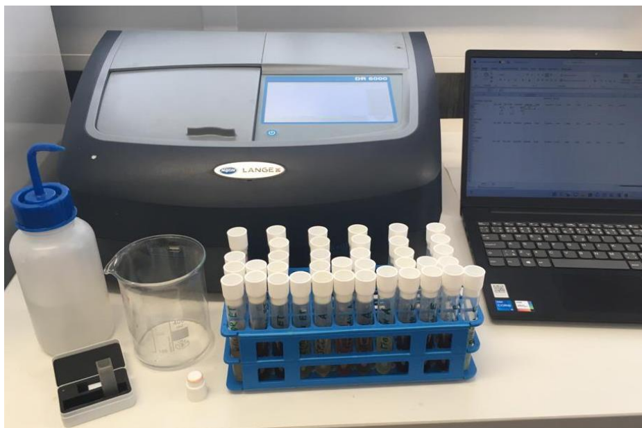
Obr. 13. Měření barvy a žlutosti u extraktů v kapalně fázi vybraných exotických dřev na UV-VIS spektrofotometru HACH DR 6000
