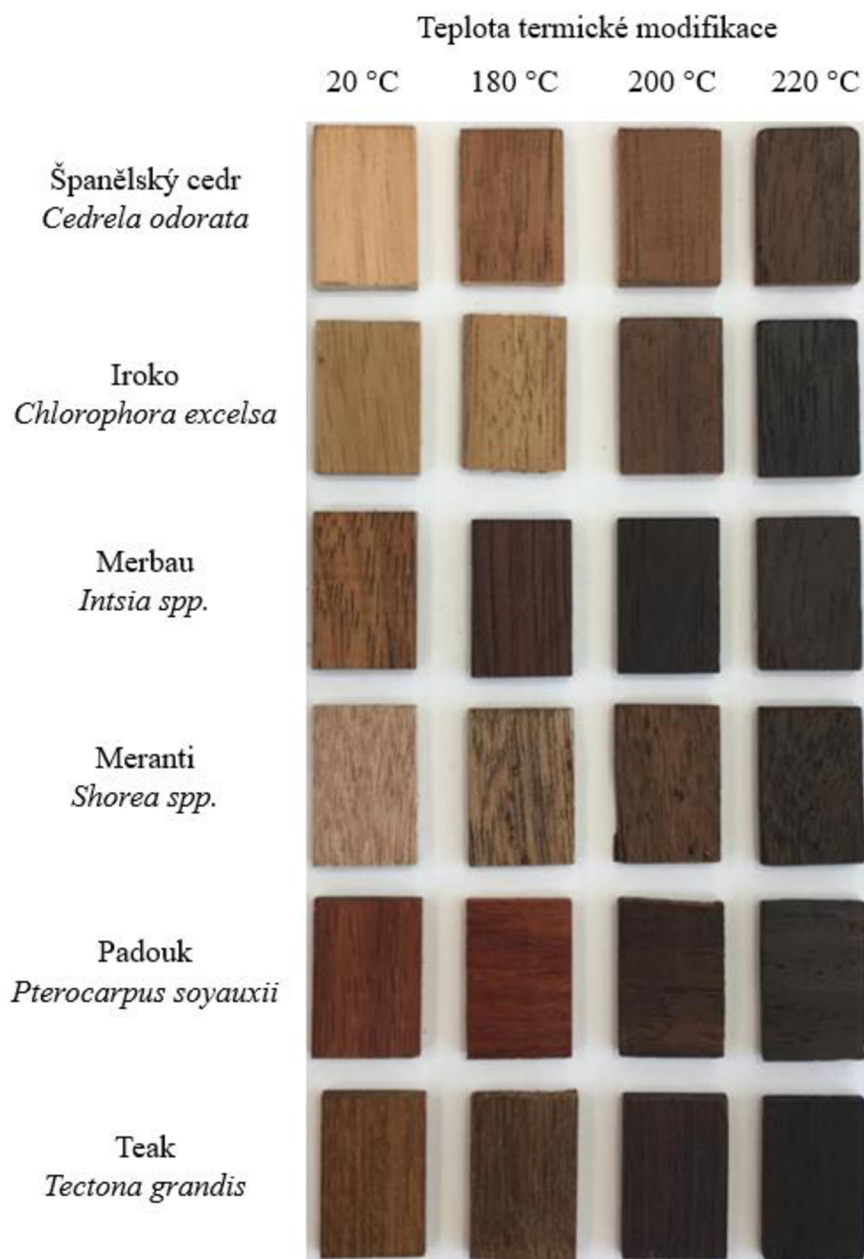
Obr. 8. Vzorky exotických dřev, pro měření UV-Vis difúzní reflektance
