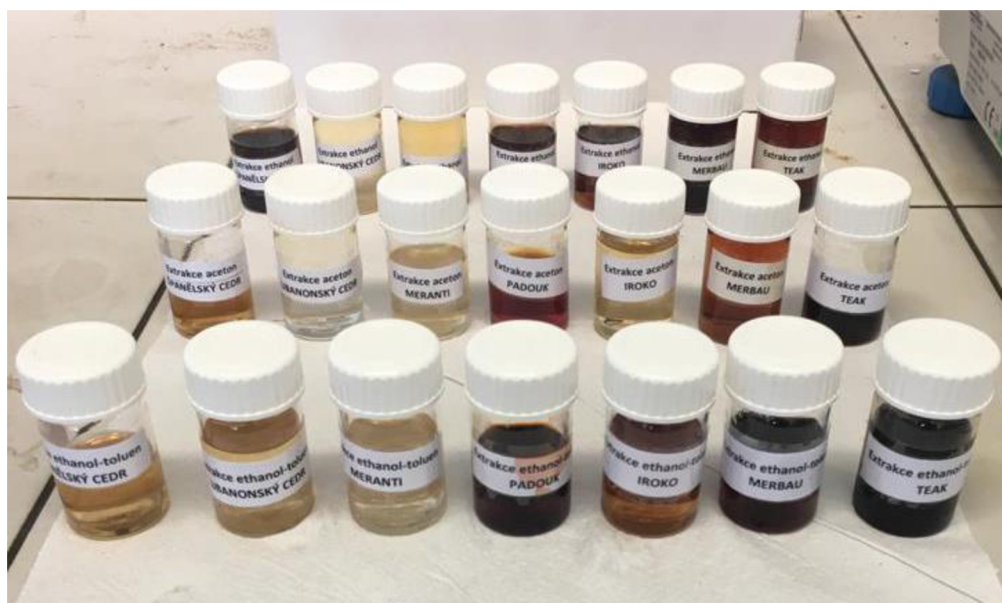
Obr. 9. Extrakce z referenčních vzorků vybraných tropických dřev, do acetonu, ethanolu a ethanol toluenu
