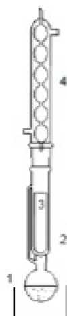
Obr. 10. Soxhletova aparatura (1 - varná baňka, 2 - extrakční nástavce podle Soxhleta, 3 - fritra se vzorkem, 4 - chladič)
