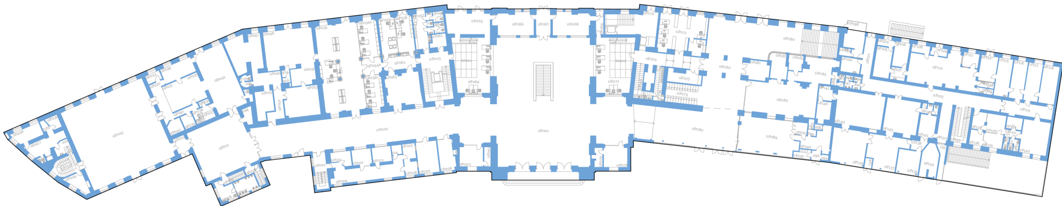
Stavající stav Půdorys 1.NP
