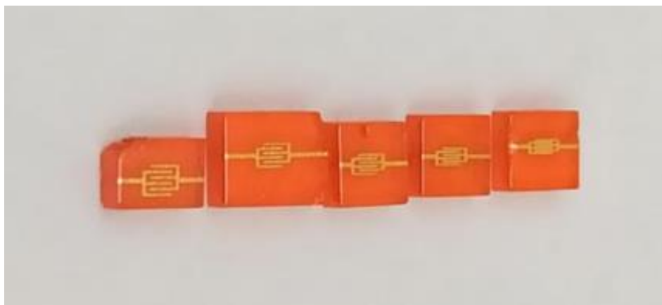
Obr. 3.2: Ukážka použitej vzorky - MAPbBr 3 s rozličnými dĺžkami kanálu. Prevzaté z [29]
