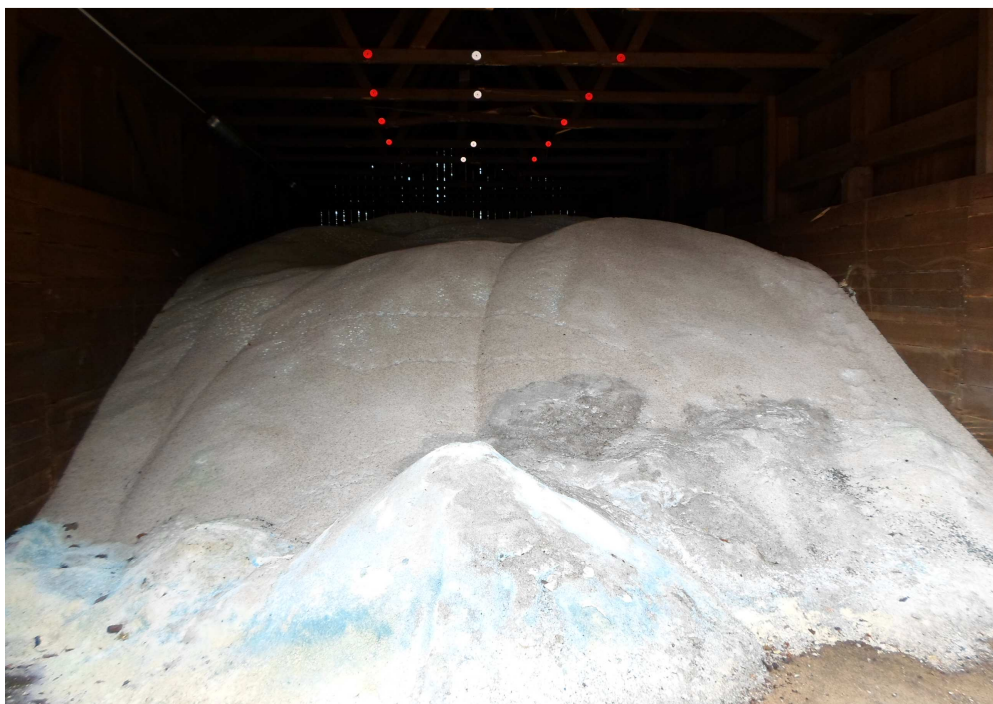
Obrázek 10: Příklad nevhodně uskladněné posypové soli (sklad není uzavřen)
