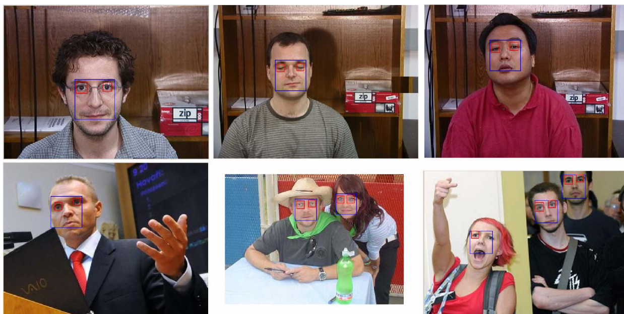
Obr. 4.30. Ukázky výsledků navrženého detektoru (nahore – obrázky z testovací databáze, dole – reálné obrázky).
