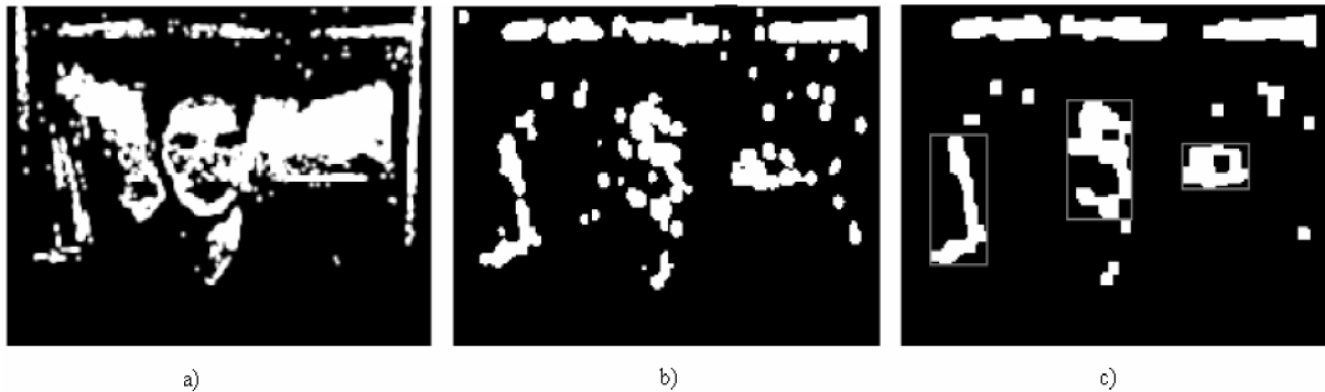
Obr. 4.10. a) zprůměrovaná binární mapa, b) vynásobená zprůměrovanými waveletovými koeficienty, c) po provedení morfologických operací s výběrem kandidátských oblastí.
