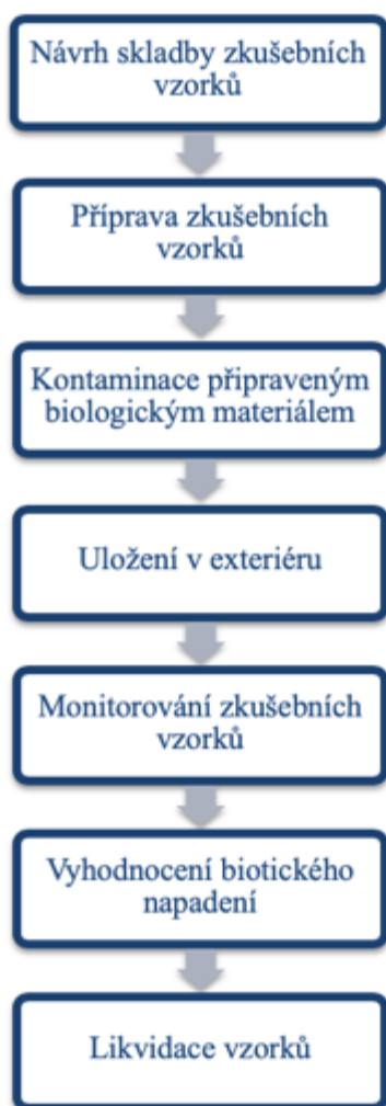
Obrázek 12 – Postup testování v exteriéru umělou kontaminací (vlevo), přirozenou kontaminací (vpravo)
