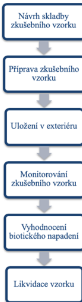
Obrázek 12 – Postup testování v exteriéru umělou kontaminací (vlevo), přirozenou kontaminací (vpravo)
