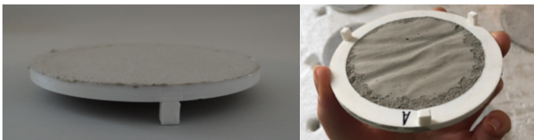
Obrázek 14 - Nanesení základní vrstvy
