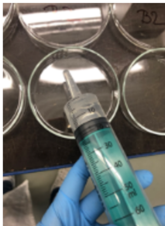
Obrázek 30 - Aplikace destilované vody pomocí plastové stříkačky
