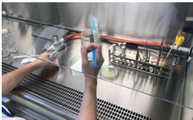
Obrázek 28 - Testování nanášení plísní na stavební materiál v laboratořích MUNI
