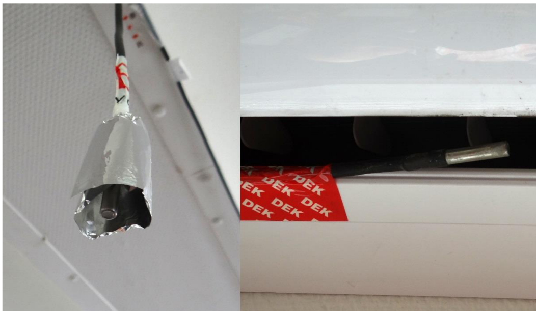
Obrázek D.2 – Vlevo sonda s radiační clonou, vpravo sonda umístěná ve výfuku klimatizace
