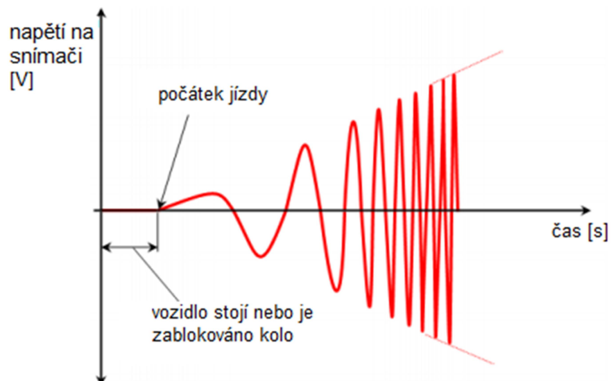
Obrázek 30: Schéma indukovaní napětí během otáčení kola [10]
