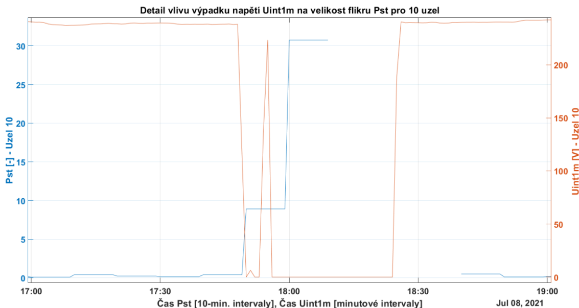
Obrázek 4.4 Detail vlivu výpadku napětí na velikost flikru P_{st}
