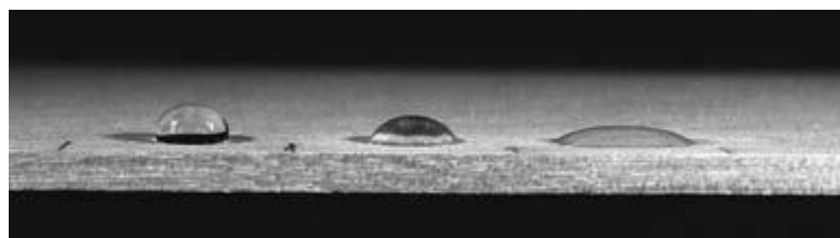
Obr. 4: Smáčivost povrchu dýhy: Vlevo - před broušením, vpravo - zlepšení po odstranění nečistot broušením (Frihart 2005)
