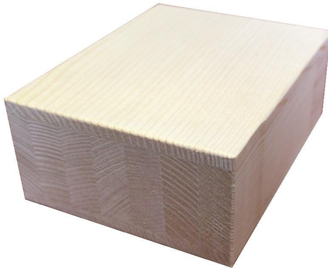
Obr. 15: Konstrukce sendvičového profilu – eurodeck (EO Ludvík 2010)
