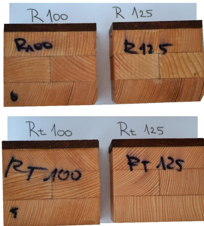
Obr. 66: Posouzení jakosti lepení pro skupiny SM+TW
