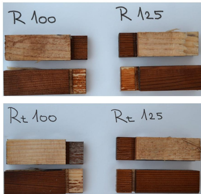
Obr. 62: Posouzení smykové pevnosti pro skupiny SM+TW – expozice č. 3
