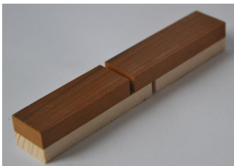
Obr. 31: Kombinovaný smrkový vzorek pro smykovou zkoušku
