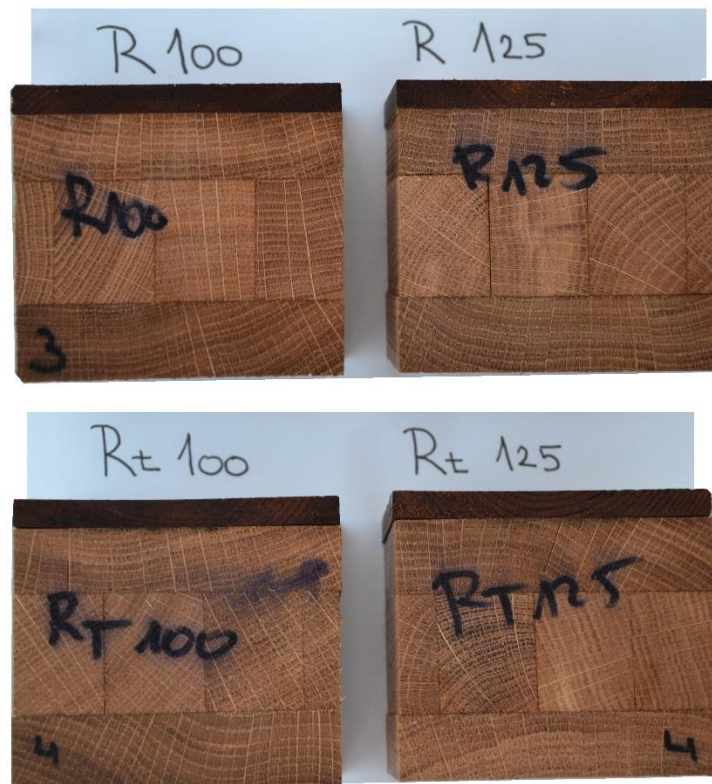
Obr. 67: Posouzení jakosti lepení pro skupiny DB+TW
