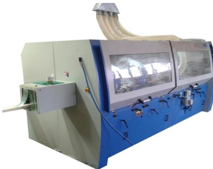
Obr. 24: Profilovací frézka Leadermac 823
