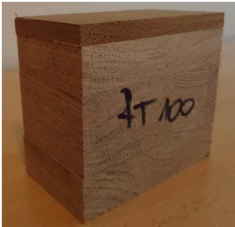
Obr. 30: Kombinovaný dubový vzorek pro temperované uložení ve vodě
