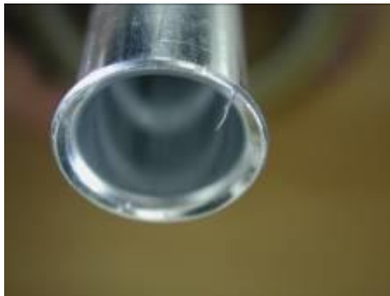
Obrázek 20 - Otřep po kartáčování (zdroj: Vlastní fotografie)
