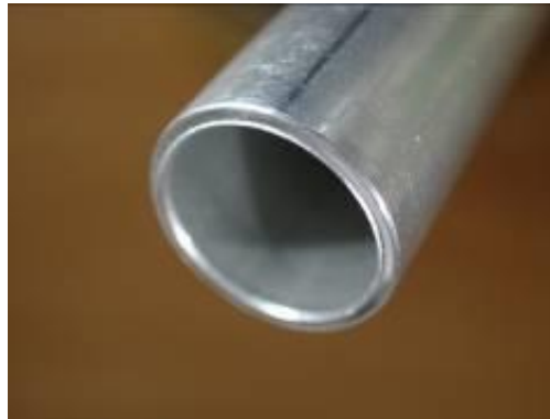
Obrázek 18 - Odjehlení konců trubek (zdroj: Vlastní fotografie)
