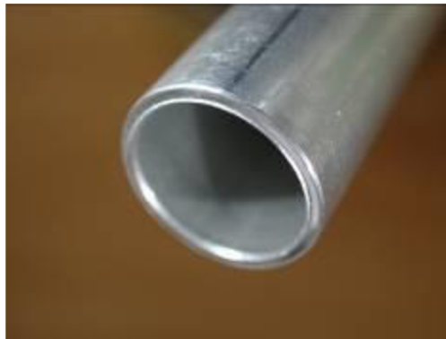
Obrázek 18 - Odjehlení konců trubek (zdroj: Vlastní fotografie)
