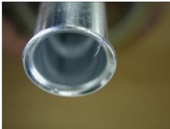
Obrázek 20 - Otřep po kartáčování (zdroj: Vlastní fotografie)
