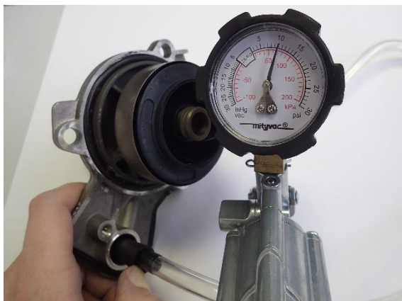
Obrázek 41 - Zkouška regulačního šoupátka
