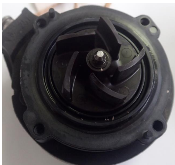
Obrázek 53 - Lopátkové kolo prvního čerpadla
