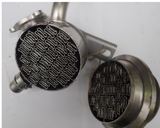
Obrázek 77 - Řez EGR chladiče
