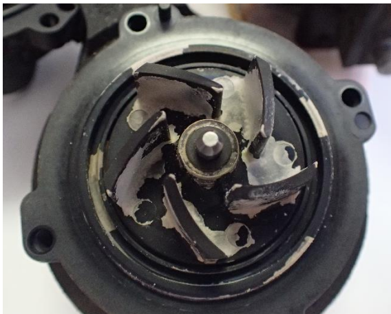
Obrázek 54 - Lopatkové kolo druhého čerpadla
