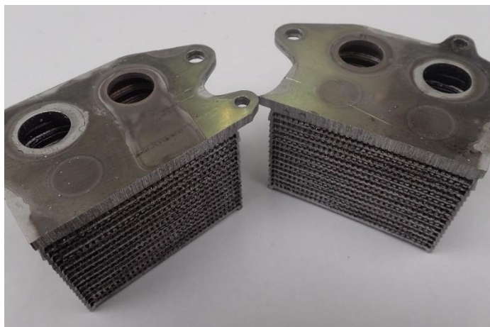
Obrázek 82 - Chladič oleje v řezu
