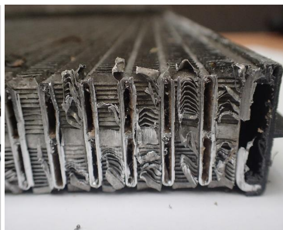
Obrázek 49 - Chladič v řezu
