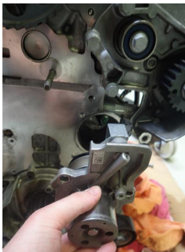
Obrázek 26 - Demontované díly, které mají spojitost s chladicím systémem
