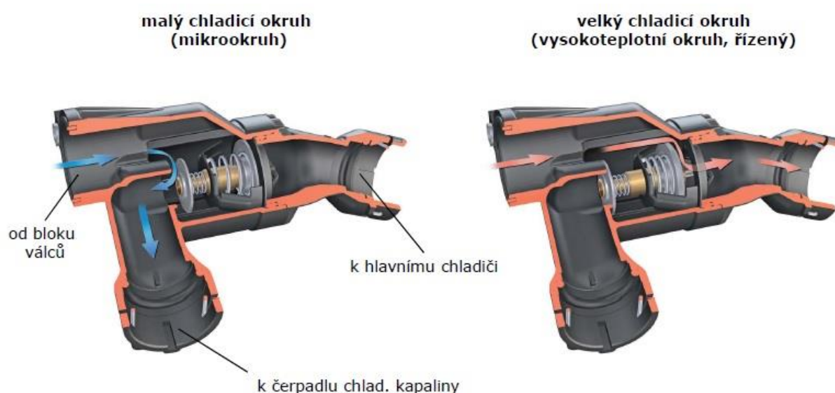
Obrázek 7 - Termoregulátor chladicí kapaliny v řezu s ukázkou aktivace
