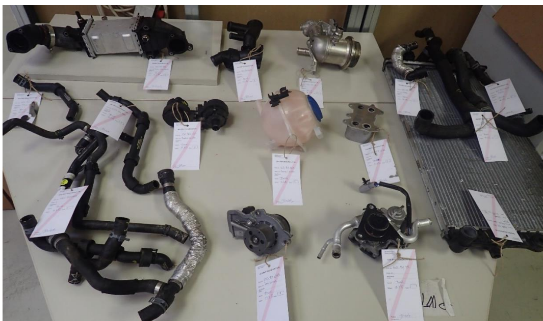
Obrázek 26 - Demontované díly, které mají spojitost s chladicím systémem
