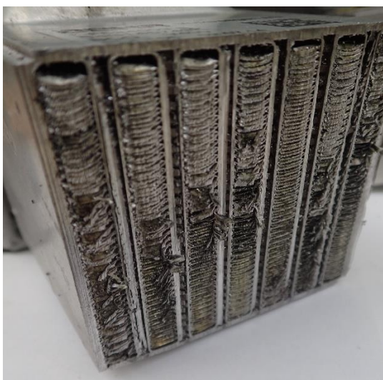
Obrázek 74 - Řez chladiče plnicího vzduchu
