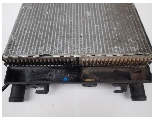
Obrázek 48 - Chladič bez postranního víka
