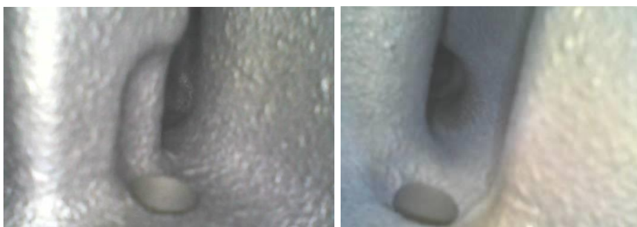
Obrázek 62 - Prostor pro kapalinu vně hlavy A Obrázek 63 - Prostor pro kapalinu vně hlavy B
