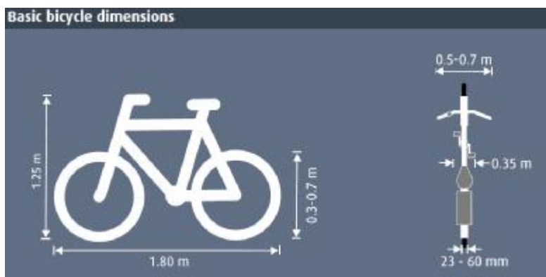
Obrázek 6 : Definované rozměry kola podle dánského Bicycle parking manualu ; zdroj [2]
