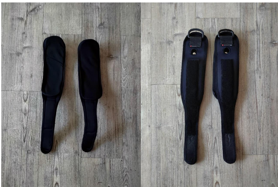
Obrázek 5 Pásky s elektrodami na paže (vlastní tvorba)
