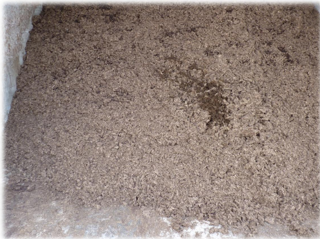
Příloha 29. Fotodokumentace odseparované pevné složky digestátu (separát Petrovice)
