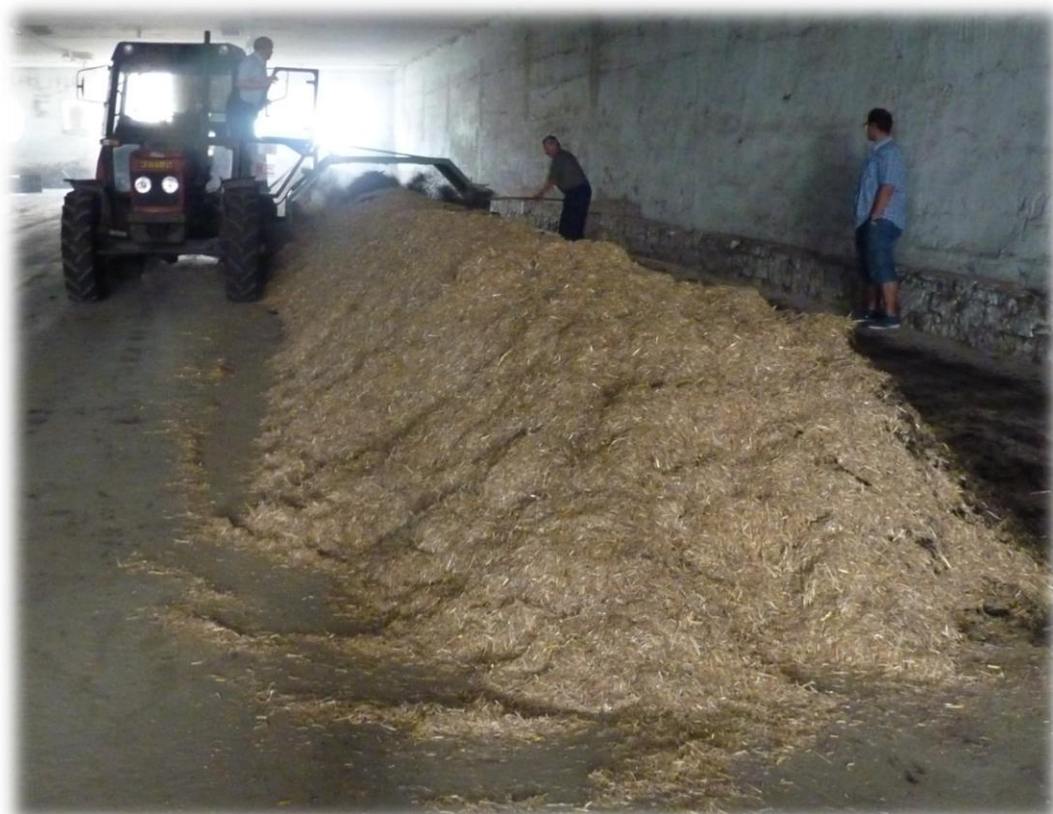
Příloha 22. Fotodokumentace homogenizace surovin (separát + pšeničná sláma) překopávačem
