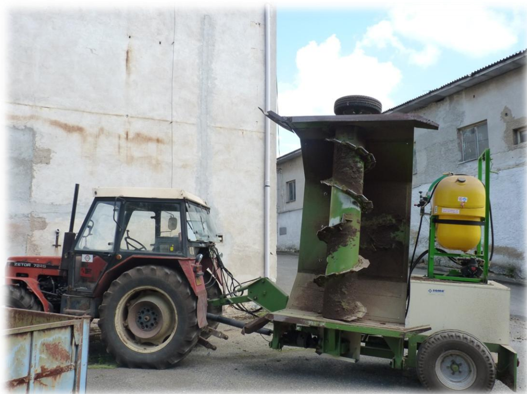
Příloha 21. Fotodokumentace překopávače využívaného k aeraci kompostů (rozměry rámu 140 x 540 cm)
