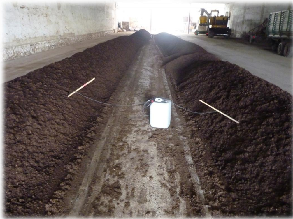
Příloha 25. Fotodokumentace ošetřování kompostů - měření teploty v kompostech
