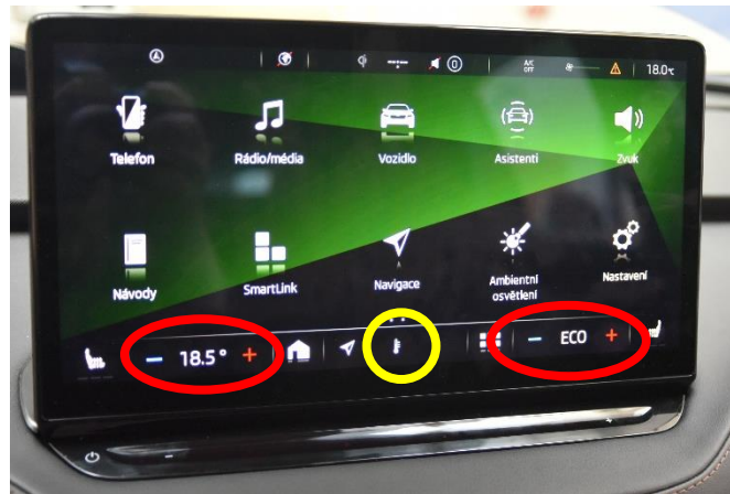
Obrázek 20 Dotykový displej vozu Škoda Enyaq iV s vyznačenými tlačítky pro ovládání teploty (červeně) a vyvoláním ovládání klimatizace (žlutě)
