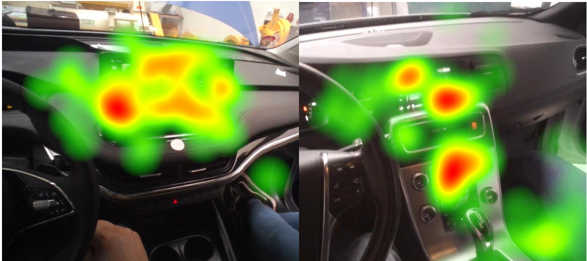
Obrázek 22 Heat mapa získaná ze sledování respondentů při ovládní navigačního systému vozů Škoda Enyaq iV (vlevo) a Volvo V60 (vpravo)
