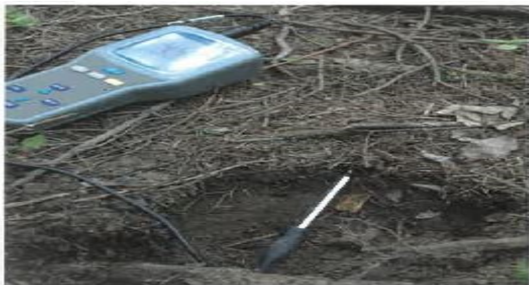
Obrázek 4: Měření pH půdy přímo na místě pomocí kontaktní pH elektrody ISFET (Šimek et al., 2019).
