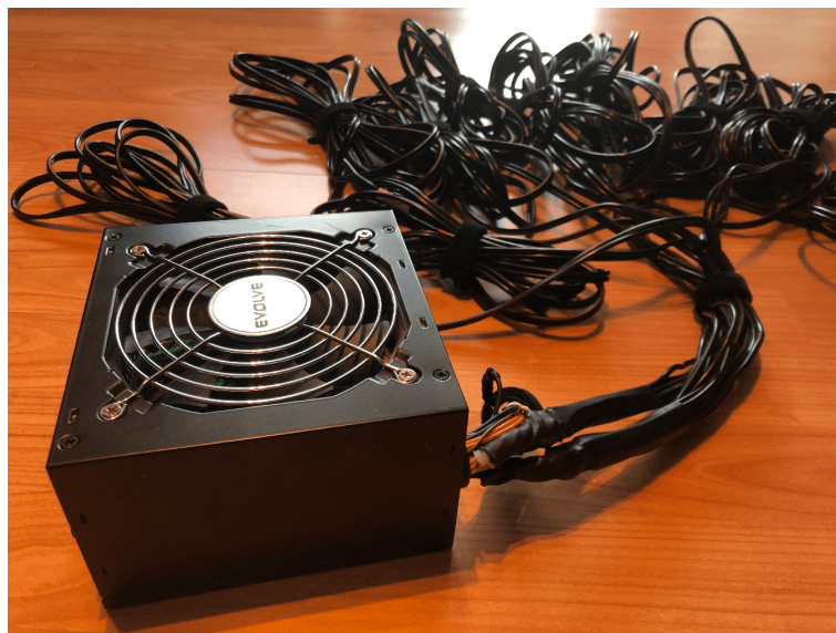
Obrázek 5.3: Upravený ATX zdroj pro napájení zámkových modulů
