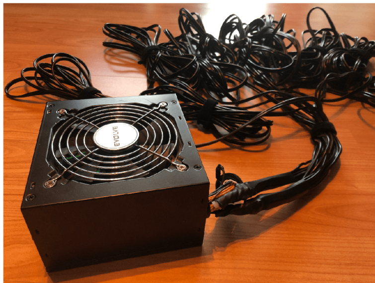
Obrázek 5.3: Upravený ATX zdroj pro napájení zámkových modulů
