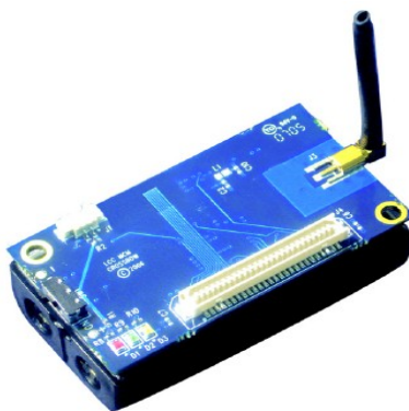
Obrázek 4.: IRIS mote pouze s radio-platfomou [11].
