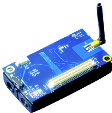
Obrázek 4.: IRIS mote pouze s radio-platfomou [11].
