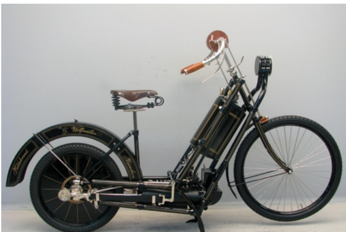
Obrázek 1 První stroj označován jako motocykl – Hildebrand & Wolfmüller ( www.bonhams.com )
