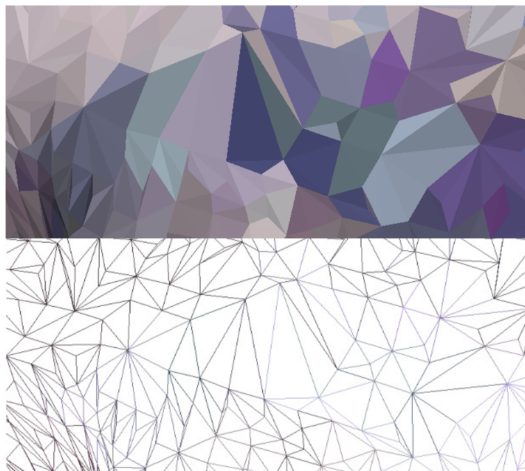
Obrázek 4.14: Stejný povrch po detekci a zalátání díry. Ve spodní části je znázorněna mřížka tohoto povrchu.
