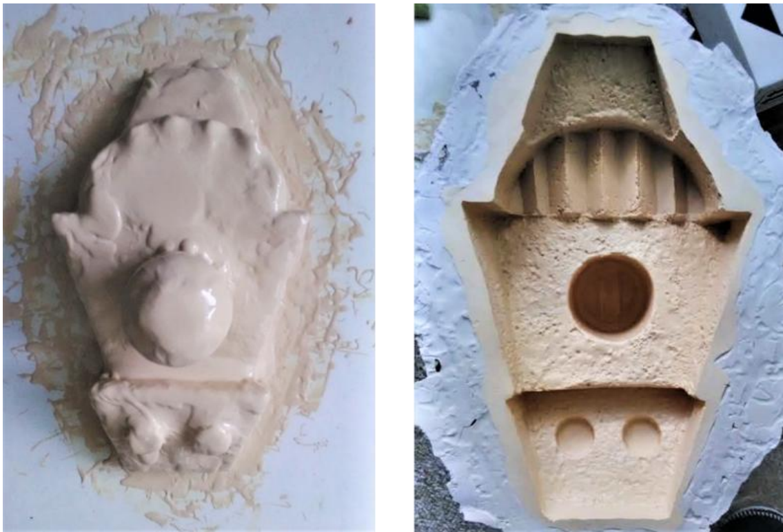
Obrázek č. 23: vzorový model zalitý v lukoprenové formě a lukoprenová forma již připravená k odlévání.
