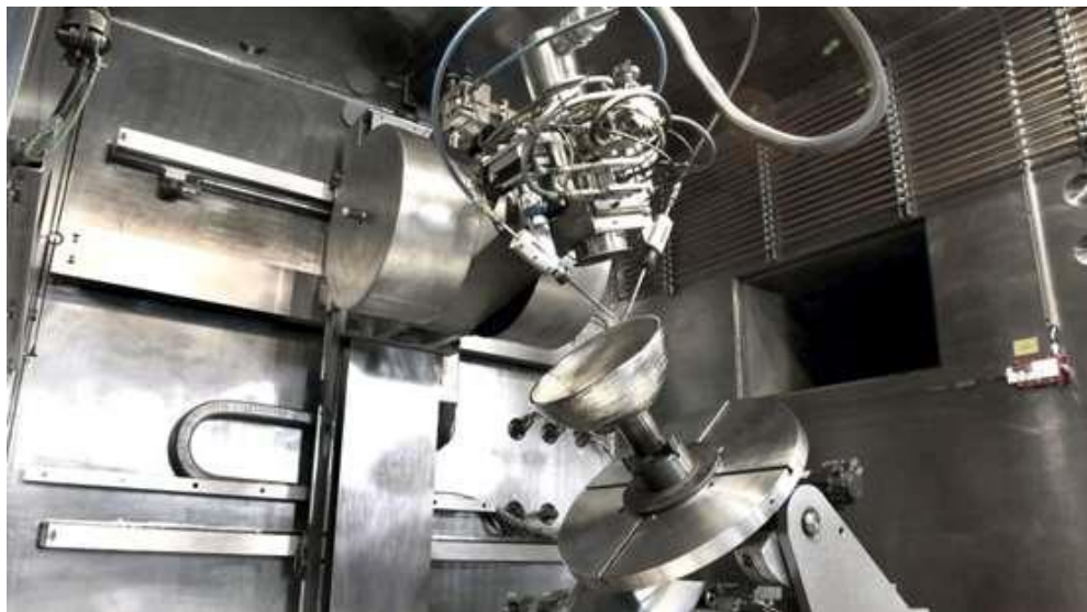
Obr. 2.6 Ukázka procesu aditivní výroby elektronovým paprskem [58].
