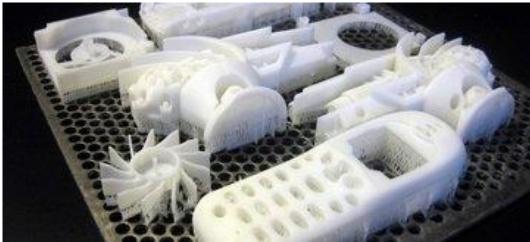
Obr. 2.2 Příklad vytištění metodou stereolitografie [23].
