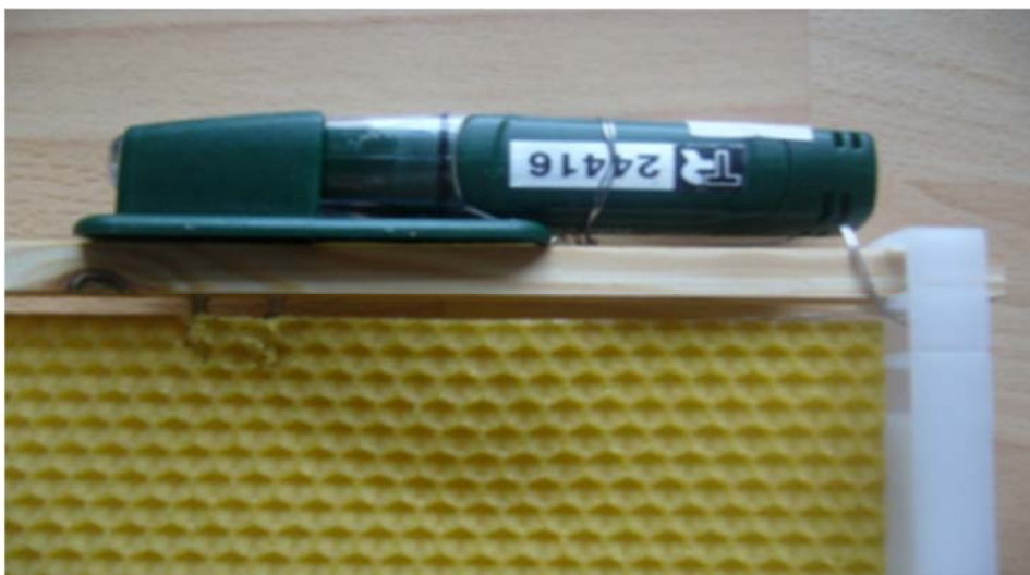
Obrázek 13: Měřák pro měření teploty a vlhkosti – vnitřní
