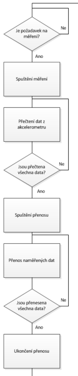
Obrázek 19 Diagram smyčky modulu pro sběr dat
