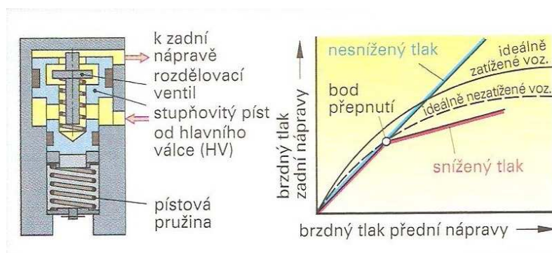
Obr. 9 Omezovač brzdného tlaku bez regulace
