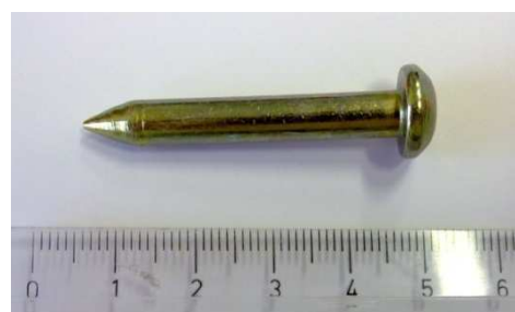
Obr.6: Měřický hřeb, stabilizace bodů ve vozovce
