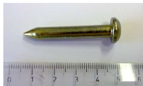
Obr.6: Měřický hřeb, stabilizace bodů ve vozovce
